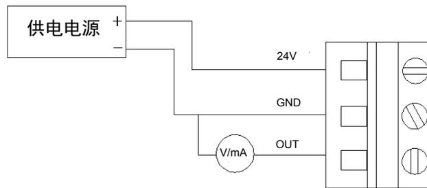
模拟输出信号可以利用S1拨码开关设置，有0~10V、0~20mA、4~20mA模拟信号输出，如果用户没有特殊要求，出厂设置一般为：0~10V信号输出
