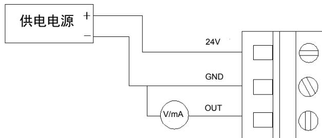
模拟输出信号可以利用S1拨码开关设置，有0~10V、0~20mA、4~20mA模拟信号输出，如果用户没有特殊要求，出厂设置一般为：0~10V信号输出
